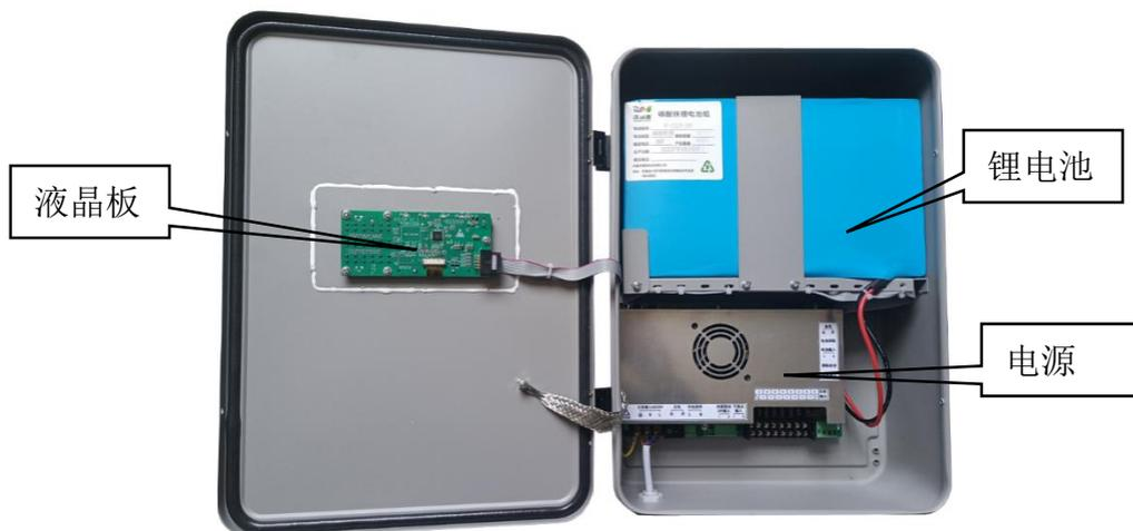
图 2-2 控制器内部结构图
