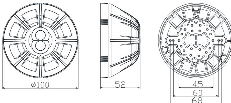
图 1 外形及安装尺寸图（不带支架）
