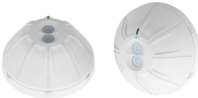
JTG-H-JBF4384A-Ex 点型红外火焰探测器（以下简称火焰探测器），使用了专门设计的两波段红外传感器件，再通过内置的高速微处理器和先进的信号处理算法，能有效的区分出真实的火焰辐射与干扰源，提高报警速度的同时，极大程度的降低了环境因素对火焰探测器的影响；优良的防爆和防护设计，满足各种工业严酷环境使用。
