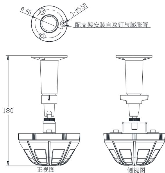
图 2 外形及安装尺寸图（带支架）
