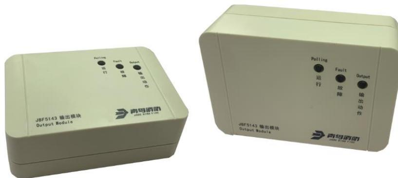
JBF5143 输出模块(以下简称模块)是青鸟消防股份有限公司开发的可配接广播系统的控制模块。该模块主要用于消防广播的控制, 并可对消防应急广播与扬声器连接线路状态以及扬声器数量进行监测。在使用过程中消防联动控制器发出命令, 通过输出模块启动或停止与该模块连接的音源以及扬声器之间的通断。
